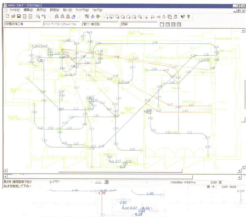
画面上のスキナーから読み込んだ図面やCAD図面データ(DXF)をマウスでクリックして、長さや個数を拾い出します。拾い出した数量データは楽王見積システムの内訳に取り込まれますので、大幅な効率アップを実現できます。
